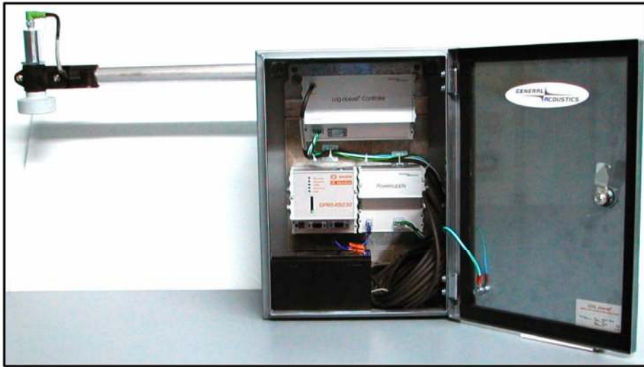
그림 1: 한 개의 초음파 센서가 장착된 모델 LOG_aLevel의 표준 장비
