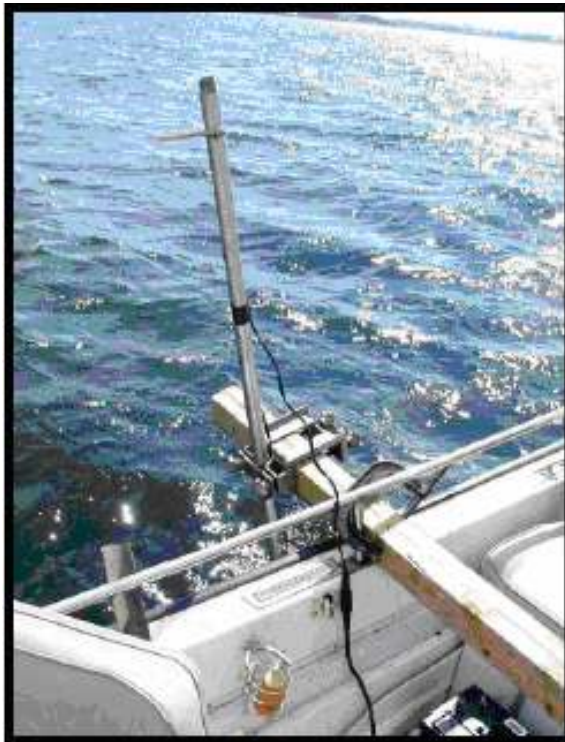
그림 2. 실제 부착 사진 ( 상부에는 GPS 수신 안테나 설치 )
